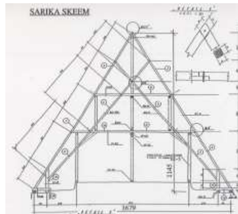
Joonis 5. Suurildi (Ajaloomuuseum) hoone katusekonstruktsioon H.Uuetalu konspektist
